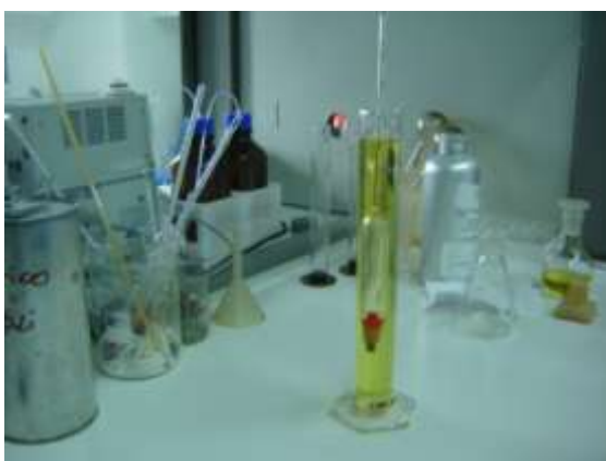
Determinazione densità con densimetro
