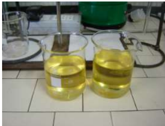
d) Biodisel dopo lavaggio con acqua e trattamento con solfato di sodio anidro
