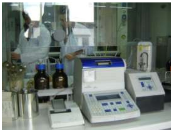
Determinazione densità con densimetro automatico
