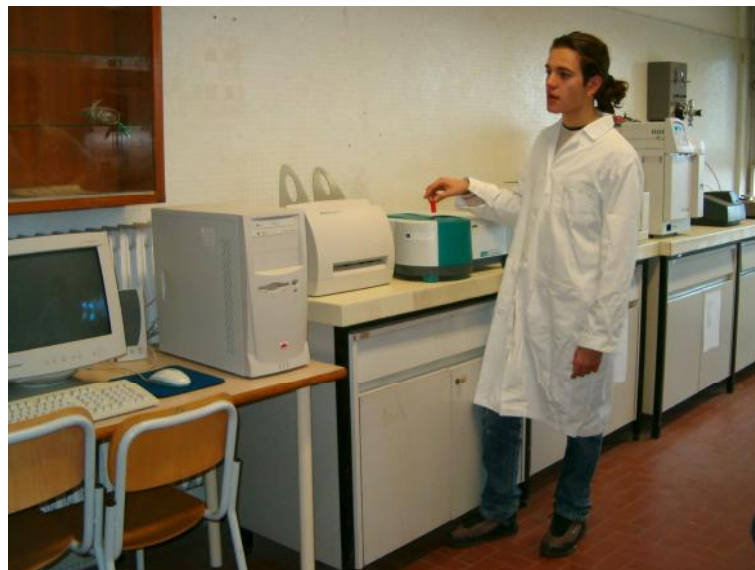
Determinazione dei fosfati nel compost (metodo al blu di molibdeno) con lo spettrofotometro.
