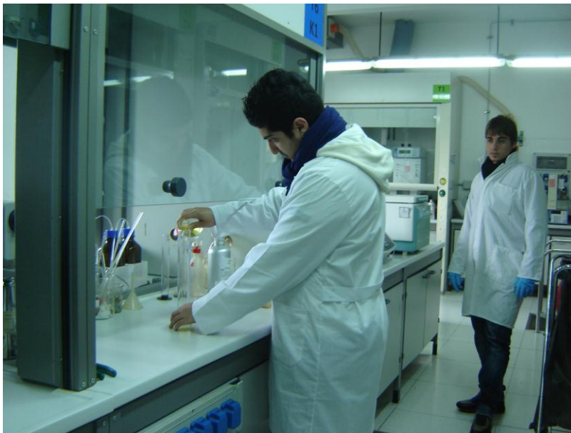
Allievi in dogana eseguono determinazioni analitiche sul biodiesel
