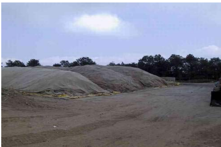
Figura 2 – Cumuli di RU indifferenziati coperti con telo Gore-Tex (Document. tecnica BIOE)
