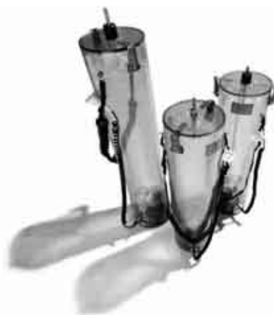
Figura 3 – I campionatori “a vacuum” per il prelievo dei campioni di aria osmogena
